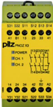
Dispositivo de seguridad (standalone), entradas: conexasiónado monocanal obicanal con o sin detección de derivación, salidas: 3 NA, 1 NC, 1 SEMIC., rearme automático/supervisado, UB 230 V AC/24 V DC, ancho: 45 mm, bornes de tornillo integrados, supervisión de parada de emergencia,puertas protectoras.
